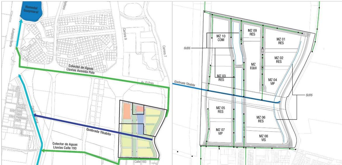
Figura 34. Drenaje pluvial presentado en el DTS del plan parcial Tibabita. Obtenido de [52]
