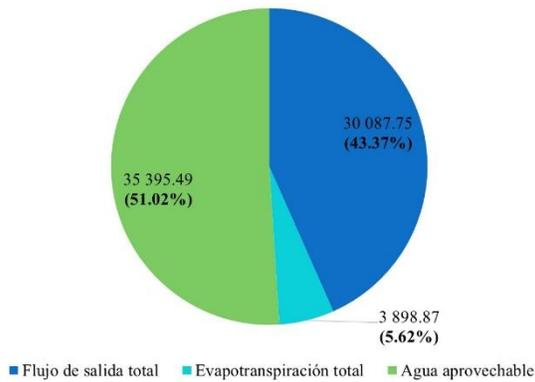
Figura 37. Flujos totales (m³/año) obtenidos para los pondajes húmedos analizados en el Tibabita
